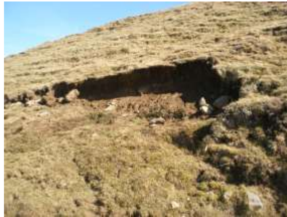
Imagen IX: Cicatriz de pequeño deslizamiento, con la morfología típico semicircular, y masa deslizada situada en una posición inferior a la cicatriz.
