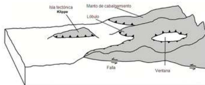
Imagen XIV: Esquema de la estructura de una ventana tectónica: Extraído de: http://es.wikipedia.org/wiki/Ventana_tect%C3%B3nica6
